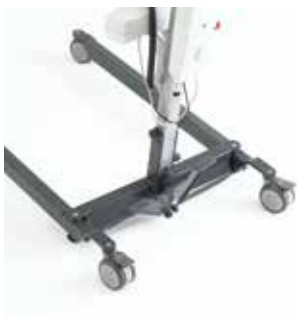
Apertura Manual Únicamente con el apoyo del pie en el pedal se ajusta la apertura/cierre de las patas.
