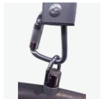
Mosquetón de seguridad Posición correcta y segura de la percha.
